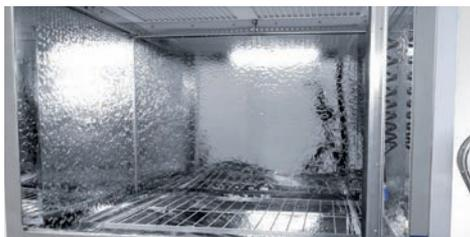
**ANALYSEBEREICH** (ca. 1200 x 800 x 800) aus poliertem Edelstahl. Für Bauteile bis zu 100 kg. Leichtes Abreinigen aller vier Wände und schnelle Erreichung von Blindwerten durch integrierte Wandspülung.
