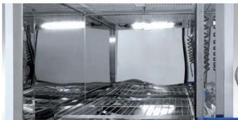
**ZUFÜHRUNG** gefilterter Luft über die Decke der Prüfmaschine. Aktiver Schutz der Bauteile und des Beckens vor Partikelkontamination. Somit ergibt sich eine Reinraumklasse ISO 5 im Analysebereich. Erhöhter Mitarbeiterschutz durch Anschluss Ihrer Absaugung an unser System.
