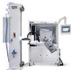
**OPTIONAL VERFÜGBARER MANIPULATOR:** Konstruiert für besonders schwere Bauteile. Ein Schwenkarm mit Drehantrieb schützt vor zusätzlicher Partikelgenerierung und entlastet den Mitarbeiter von unergonomischen Bewegungen.
