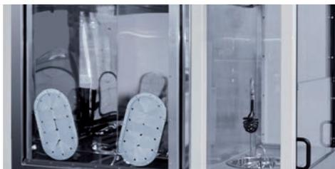
**DOPPELARBEITSPLATZ:** Zwei Analysebereiche aus poliertem Edelstahl für unterschiedliche Bauteilgeometrien vom mg-Bereich bis zu 100 kg. Becken 1: ca. 800 x 800 x 800 mm. Becken 2: 300 mm Halbkugel mit Ultraschall.
