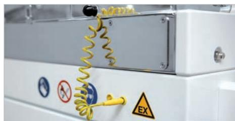
**UMFASSENDES EXPLOSIONSSCHUTZKONZEPT:** Verhinderung einer explosionsfähigen Atmosphäre im Analyseraum: Doppelt gesicherte Zündschutzsysteme, über den Standard erhöhte Sicherheitstechnik, Erdungsanschlüsse uvm.
