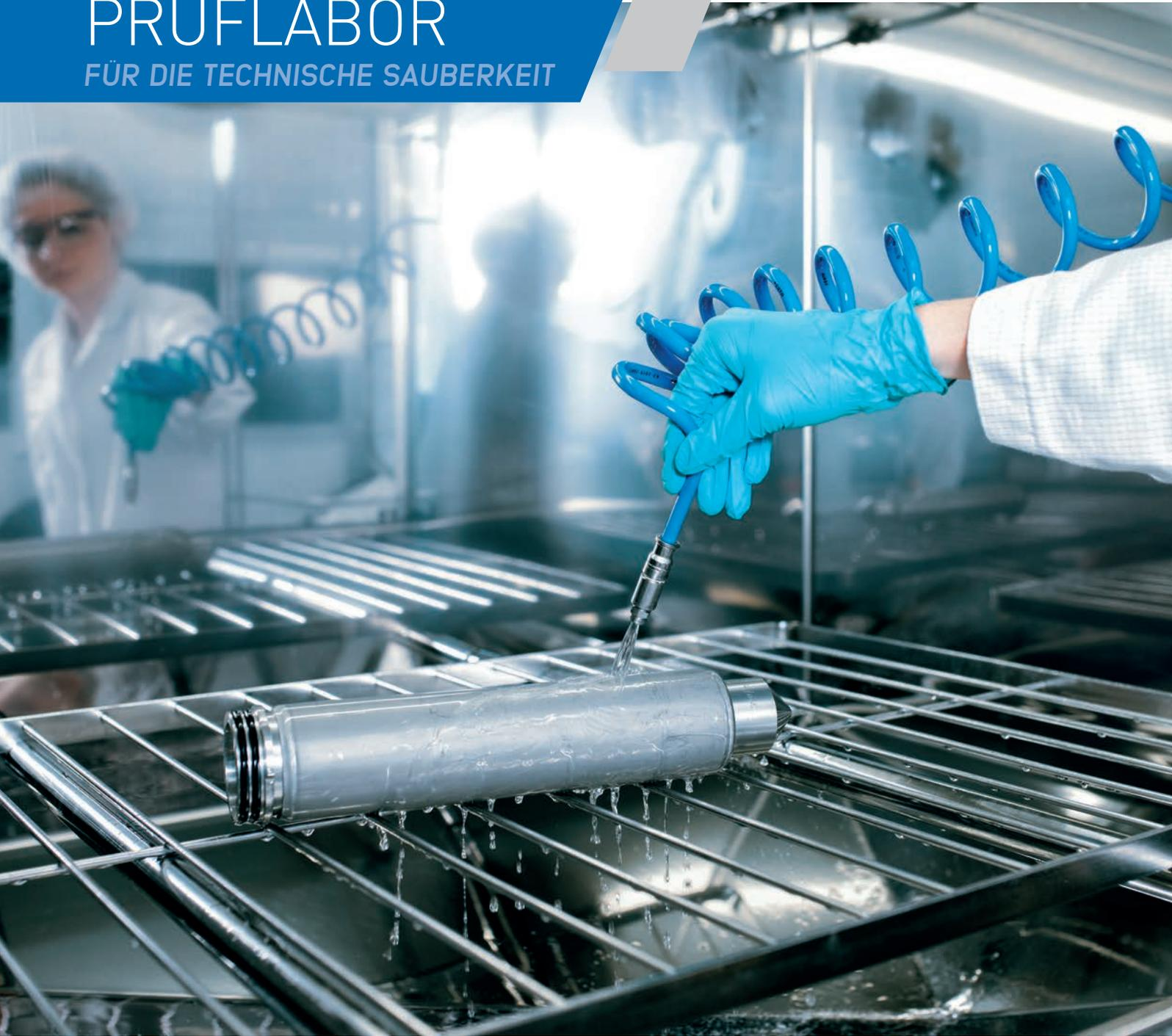
Als Pionier im Bereich der Technischen Sauberkeit betreiben wir seit 2002 erfolgreich unser eigenes akkreditiertes Prüflabor. Auf über 200 m<sup>2</sup> Fläche, welche im Reinraum mit modernster Labortechnik ausgestattet ist, untersucht unser hochqualifiziertes Laborteam funktionsrelevante Bauteile und Komponenten auf Technische Sauberkeit gemäß VDA 19.1, ISO 16232 oder firmeninternen Normen.
