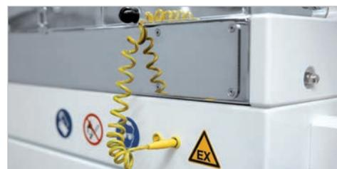
**UMFASSENDES EXPLOSIONSSCHUTZKONZEPT:** Verhinderung einer explosionsfähigen Atmosphäre im Analyseraum: Doppelt gesicherte Zündschutzsysteme, über den Standard erhöhte Sicherheitstechnik, Erdungsanschlüsse uvm.
